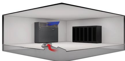
**Suministro frontal por la parte superior con plénium y rejilla y retorno frontal:** Específicamente diseñada para utilizarse en pisos elevados y dentro de la sala, esta configuración toma ventaja de la construcción de las salas típicas de computadoras. Se pueden solicitar filtros adicionales para proteger las computadoras y los dispositivos periféricos sensibles.
