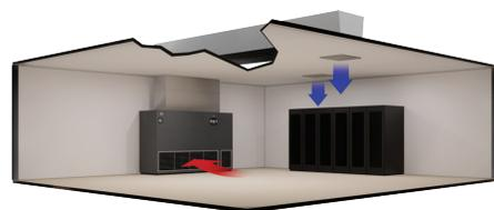
**Suministro frontal por la parte superior y retorno frontal:** Concebido para instalaciones en el espacio con conductos, este diseño de flujo de aire se utiliza comúnmente para las telecomunicaciones o para las industrias. Se pueden seleccionar opciones de filtración y presión estática elevada.
