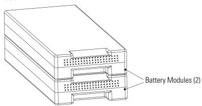
Figure 4. Battery Modules per Slot
