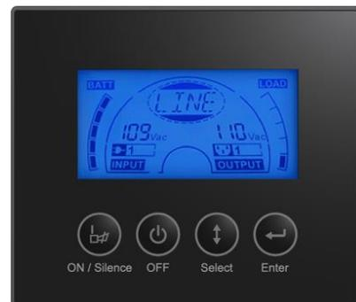
Display LCD con información clara del estado y mediciones del UPS
