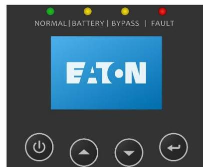
Display LCD con información clara del estado y mediciones del UPS
