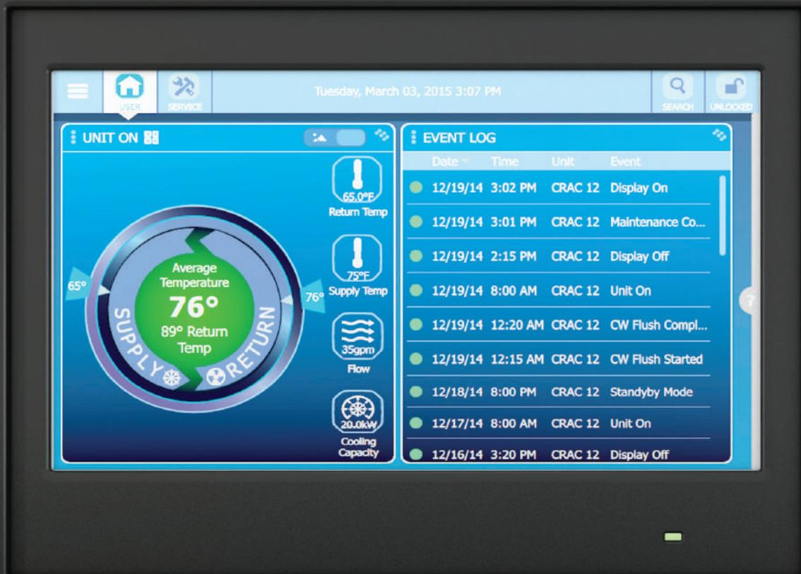
*El control iCOM™ supervisa las variaciones de temperatura y humedad, para adaptar inmediatamente el rendimiento del Liebert CRV a las condiciones de la carga.*
